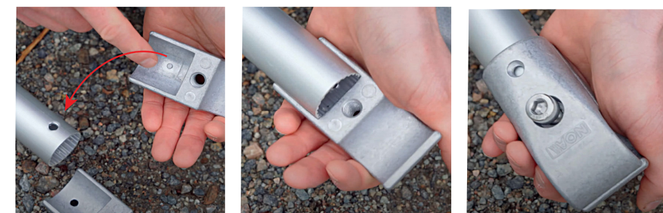
1. Den Dorn auf das Loch am Rohr ausrichten 2. Die Hälfte mit Gewinde und Dorn festhalten 3. Zweite Hälfte aufsetzen und Innensechskantschraube festziehen
